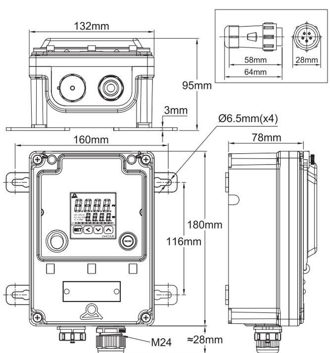
Modelo con un conector de 5 vías y una glándula de cable
