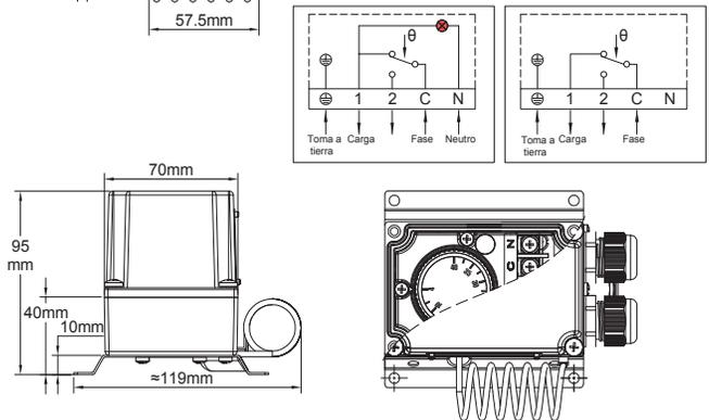
Ejemplo de montaje en dos cables de control de temperatura de un Y1B2P, en combinación con una caja de distribución Y29.
