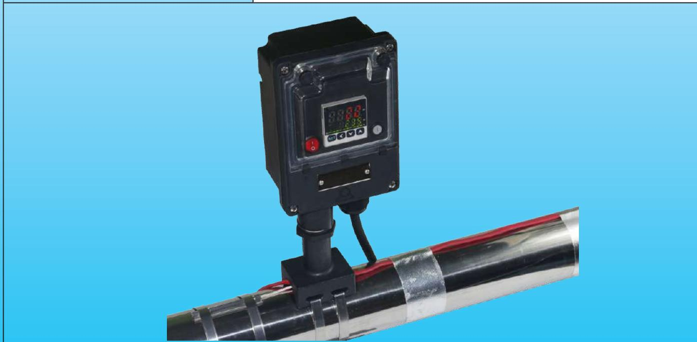
Ejemplo de montaje en tubería
