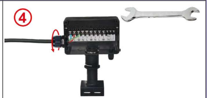
**4:** Deslizar la junta de cable redondo en la glándula de cable y apriete la tuerca. Par de apriete máximo 6 N.m.
