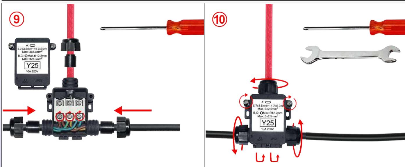
**9 :** Inserte la parte pelada de los conductores de suministro de energía en los terminales y apriete con un destornillador. 2 conductores dentro de cada terminal, en cada lado de la arandela. Par de apriete recomendado: 1,2 Nm.
