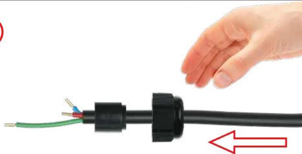
1 : Retirar el aislamiento exterior en el cable redondo según lo solicite el dibujo. Eventualmente, crimpado de zapatas de cable. Deslizar la tuerca de glándulas de cable en el cable. Seleccione la junta compatible con el diámetro y deslícela en el cable.
