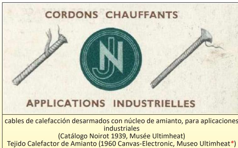
*Otra aplicación importante es la de los cordones calefactores, que consisten en una cuenta de amianto calibrada sobre la cual se enrolla el conductor metálico y se cubre (o no) con trenzado de amianto u otras sustancias aislantes".*
