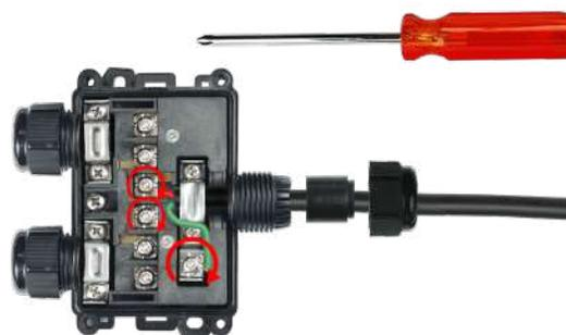
2 : Coloque los cables neutro, de línea y tierra dentro de los terminales roscados y apriételes. Par de apriete recomendado: 1,2 Nm.
