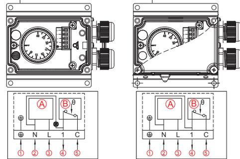
(A) Circuito electrónico (B) Relé Máx 16 A 240V res.
