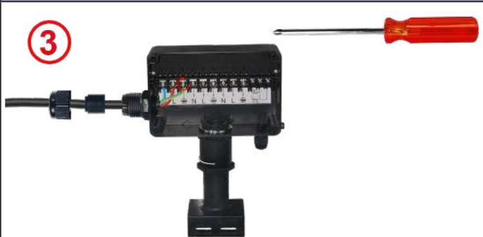
**3:** Deslizar el cable de tierra dentro del terminal de tierra y apriete el tornillo. Par de apriete recomendado: 1,6 Nm
