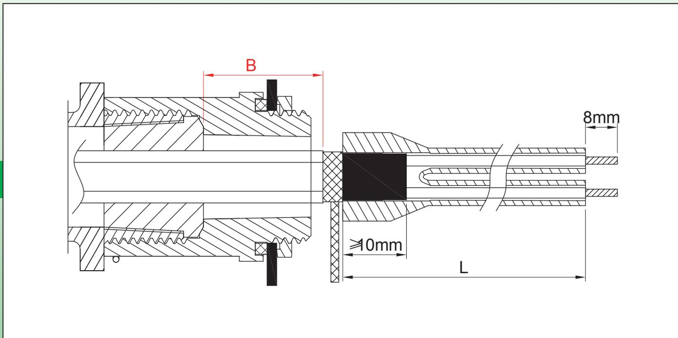
La distancia **B** debe mantenerse al mínimo para evitar el calentamiento en el interior del gabinete. La longitud **L** depende de la distancia a los terminales de conexión.
